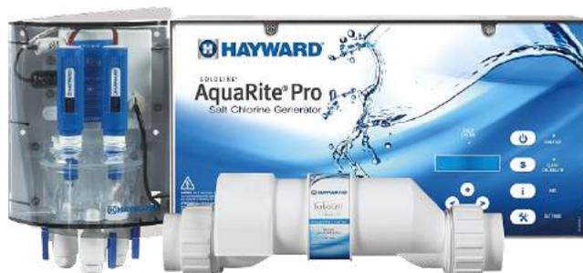
Ce traitement vous permet de désinfecter l'eau de la piscine sans ajout de produits chimiques. Le sel est converti en désinfectant dans sa cellule d'électrolyse. Les micro-organismes sont détruits, les matières organiques sont oxydées et le désinfectant retourne en sel grâce aux rayons du soleil. L'appareil régule également le PH de l'eau. Peu de consommation de sel, pas d'eau à changer, pas d'odeurs, pas de soucis !
